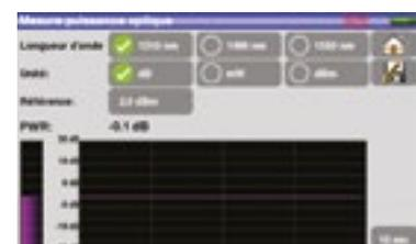
Mesure de puissance optique sur l'entrée fibre optique
