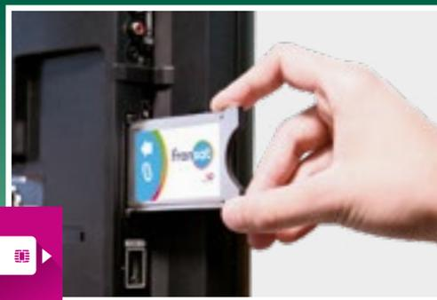
Le module FRANSAT doit être utilisé avec les modèles de TV équipés d'un tuner satellite et d'un port CI+ 1.3 et 1.2 compatibles FRANSAT
