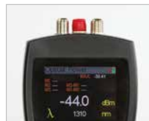
Mesure du niveau et affichage des pertes grâce à son entrée optique
