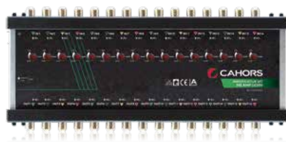
Ampli variable 16 entrées / 16 sorties avec atténuateurs 0-20 dB
