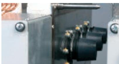
**ÉTAPE 4 :** serrer les butées mécaniques, approcher et raccorder les 2 tableaux à l'aide des goujons mécaniques de guidage
