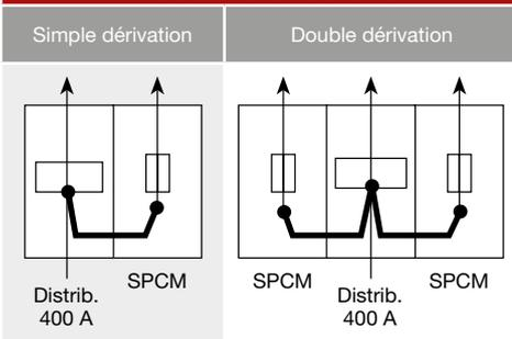
Ces kits de dérivation se raccordent sur un distributeur 400 A en superposition du câble principal. L'autre extrémité se raccorde à un SPCM. Ils permettent la dérivation d'une ou deux canalisations de forte puissance jusqu'à 120 kVA. Ils sont constitués de quatre liaisons équipées d'embouts de câbles.
