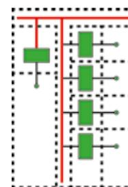
Séparation des jeux de barres et des appareils, des appareils entre eux, et des bornes de sorties entre elles.
