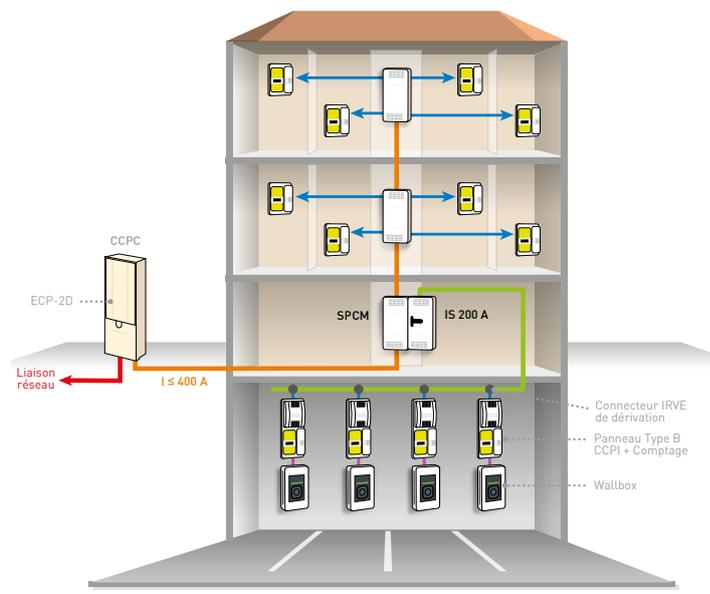
Le tronçon qui alimente les bornes de recharge est du domaine de la norme NF C 14-100. Chaque borne de recharge dispose d'un point de livraison GRD. Un coffret interrupteur sectionneur est positionné à l'origine du point de raccordement. Le tronçon est installée à la demande du syndic ou du bailleur. L'équipement du point de livraison se fait à la demande de l'utilisateur.
