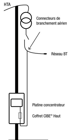
Schéma de raccordement concentrateur
