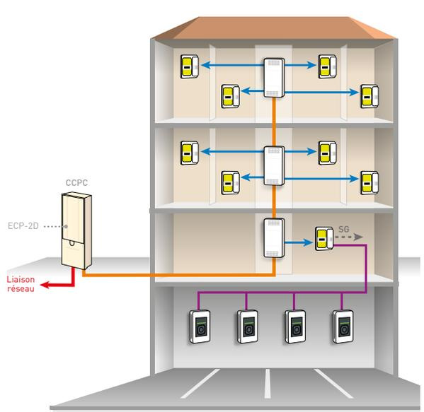
Raccordement d'un parking intérieur à l'aval des services généraux colonne électrique de l'immeuble ou point de livraison dédié. La copropriété peut également déléguer le service de la recharge à un opérateur de bornes ou demander au gestionnaire de réseau de distribution d'effectuer une prestation de décompte.
