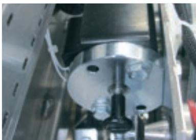
Déclencheur de fermeture avec bobine à émission
