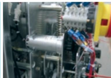
Mécanisme commande Tumbler motorisé
