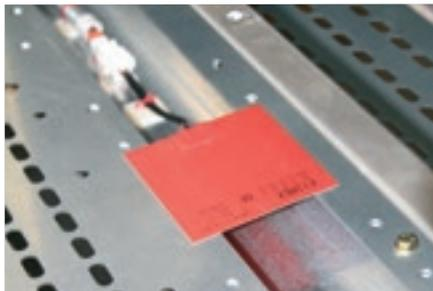
Résistance de chauffage et d'anti condensation
