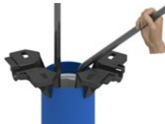
Exemple de raccordement à 135° avec pied de renfort (renforcement de la stabilité)
