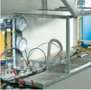
Banc d'essais hydraulique (tenue en pression, pertes de charges, débit)
