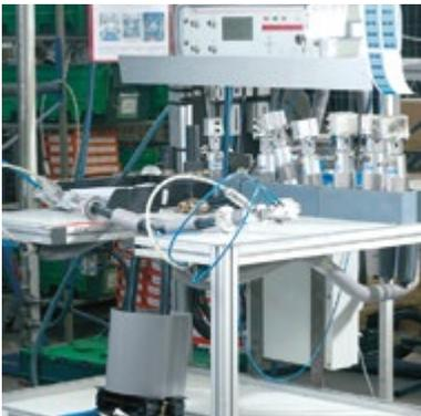
Banc de test d'étanchéité en production de type air/air
