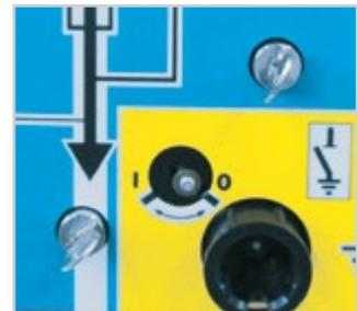
Verrouillage par clés de sécurité
