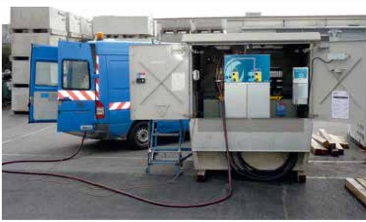
La tension est appliquée pour vérifier les propriétés diélectriques des câbles MT
