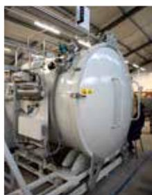
Essai de détection des fuites de SF<sub>6</sub> au niveau des cuves réalisé dans notre usine CAHORS
