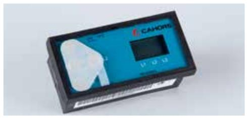
Système de détection de tension, VDS
