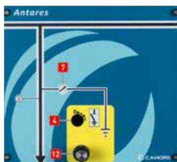
Arrivée directe avec sectionneur de mise à la terre (AD)
