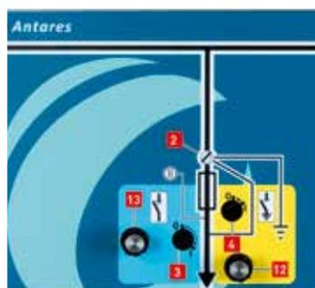
Départ avec fusibles/ interrupteur-sectionneur associés (IFA)
