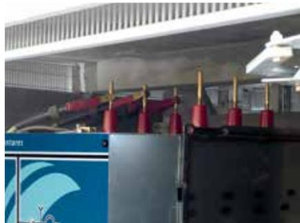
Câblage des prises d'injection de tension
