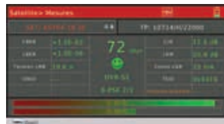
Mesure puissance et qualité du signal Satellite
