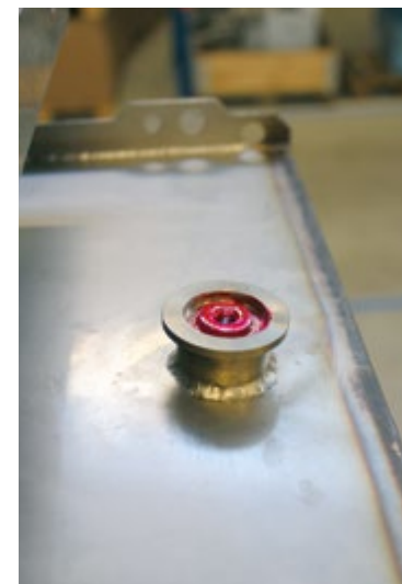
Valve de récupération du SF6 en fin de vie
