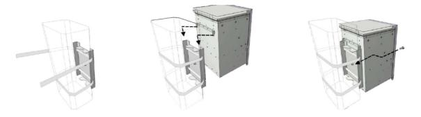
La platine peut se fixer sur le plat ou dans l'angle d'un poteau rectangulaire ; elle peut également être cerclée sur un poteau rond
