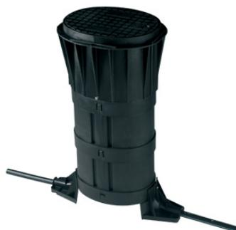
Regard compact de branchement raccordant les abonnés au réseau de distribution d'eau potable. Intègre les fonctions coupure, comptage et anti-retour.
