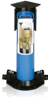
Arqueta compacta de derivación coaxial para conexión de los abonados a la red de distribución de agua potable. Funciones de corte, medida y antirretorno.
