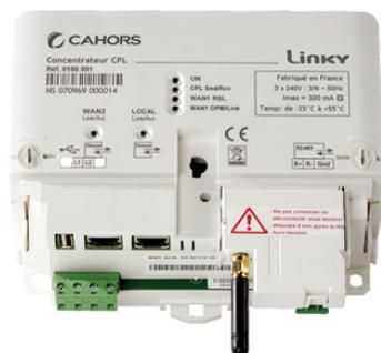
**Concentrateur permettant d'interroger des compteurs, de traiter et stocker les informations qu'il reçoit, et de les transmettre à un Système d'Information centralisé.**
