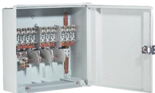
Coffrets électriques de limite de propriété destinés à la mise en place de points de protection par fusibles 22 x 58 80 A, T00 125 A, T0 160 A et T1 250 A pour le branchement des habitats collectifs.
