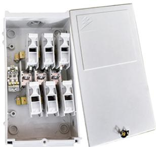
Les coffrets de distribution collective 445, Novinter, et Paninter permettent de réaliser des colonnes électriques avec des groupements de protection à chaque étage. Ils intègrent une protection par fusible des dérivations individuelles de branchement.
