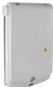
Le Point de Raccordement d'Immeuble (PRI) est situé en bas d'immeuble. Utilisé dans le cadre d'un câblage monofibre, il permet de raccorder le câble RISER d'immeuble au câble de l'opérateur télécom FTTH.
