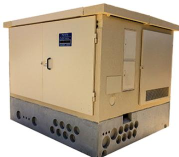
Poste Urbain Compact de 250 à 630 kVA, raccordé en antenne ou en coupure d'artère au réseau de distributeur d'énergie en 15 ou 20 kV.
